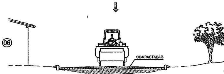
AS PEDRAS SOB A CAMADA DE AREIA DEVEM SER BATIDAS INDIVIDUALMENTE COM COMPACTADOR MANUAL TIPO PLACA VIBRATÓRIA E EM SEGUIDA PASSA-SE O ROLO COMPRESSOR, COMEÇANDO PELO PONTO DE MENOR COTA PARA O DE MAIOR COTA NA SEÇÃO TRANSVERSAL. O NÚMERO DE PASSADAS, ASSIM EXECUTADAS, É DE 3 VEZES NO MÍNIMO.
